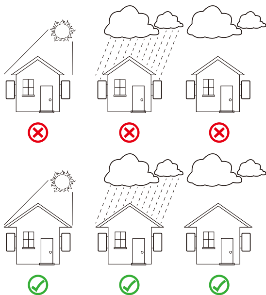
图4.1 建议安装位置
