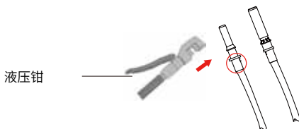
图6.4将触点引脚压接到导线上
