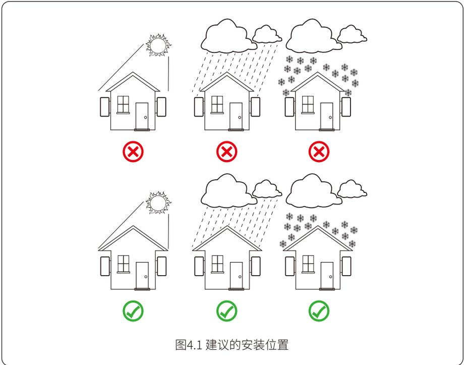
图4.1 建议的安装位置
