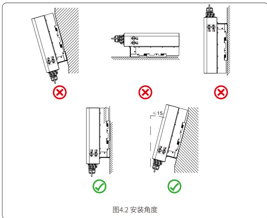
图4.2 安装角度
