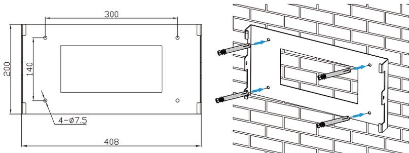
图4.5 逆变器支架的安装
